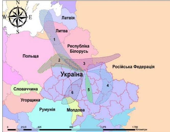
Рис. 1. Формування радіоактивних шарів у відповідності з метеорологічними умовами для миттєвих викидів у наступні дати і час (за Гринвічем): 1) 26 квітня 1986 року, 00:00; 2) 27 квітня, 00:00; 3) 27 квітня, 12:00; 4) 29 квітня, 00:00; 5) 2 травня, 00:00; і 6) 4 травня, 12:00
