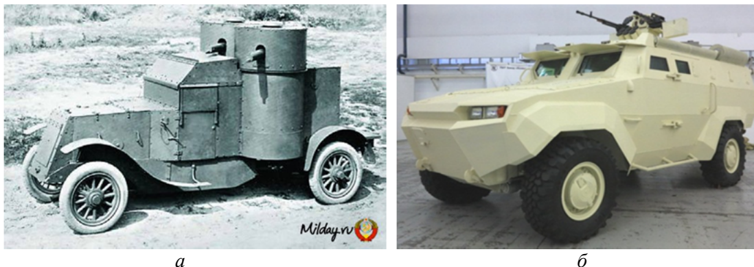
Рис. 1. Еволюція колісних бронемашин 4x4: а – «Русский Остин» («Руссо-Балт», Росія 1920 р.); б – «Тритон-01» («ПАТ «Завод «Ленінська кузня», Україна 2015 р.)
