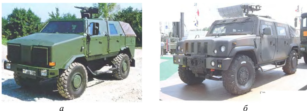
Рис. 4. Характерна форма броньованого корпусу бойових машин другого ешелону Дінго (Германія) (а) та Івеко (Італія) (б)
