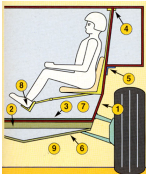
Рис. 5. Схематичне зображення критеріїв протимінного захисту високого рівня
