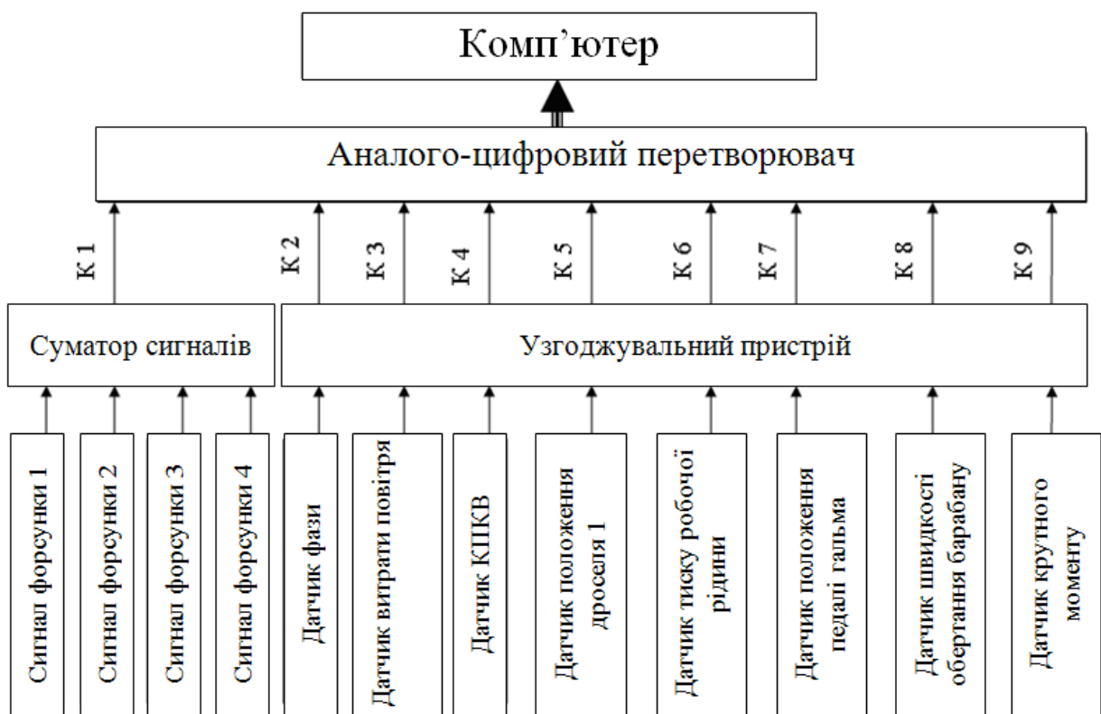
Рисунок 4.2. - Схема підключення датчиків та виконавчих пристроїв двигуна і стенда до системи збору даних
