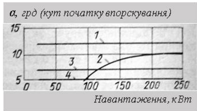
1 - зниження тиску при відкритті сопла, 2 - напрямна голки форсунки пошкоджена, 3 - нормальна робота сопла, 4 - підвищення тиску при відкритті сопла Рисунок 6.4 - Залежність кута початку впорскування палива від різних несправностей
