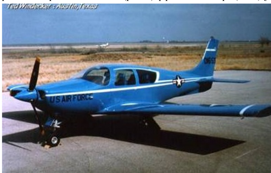
Рис. 1. Суцільносклопластиковий літак «Ігл 1» фірми «Віндекер»
