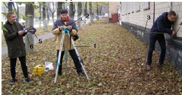
Рис. 4. Вимірювання контрольної відстані з використанням рулетки
