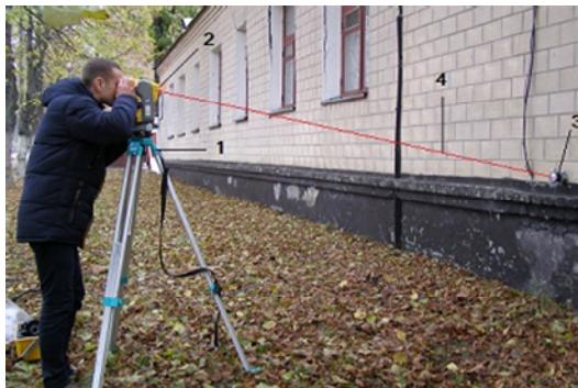
Рис. 3. Вимірювання відстані за допомогою електронного тахеометра Trimble 3305 DR у комплекті з новим пристроєм для прив'язки до сінних знаків
