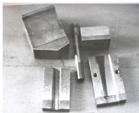
Рис. 4.7. Зразки ріжучого (а) та штампового(б) інструменту, отриманого дифузійним зварюванням у тліючому розряді
