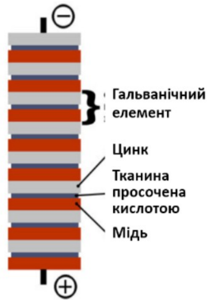
Рис. 8. Схема вольтового стовпа
