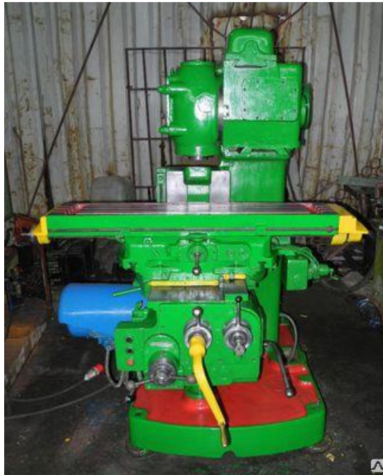
Рисунок 11.8 – Універсальний консольно-фрезерний верстат з поворотною голівкою 6H81A
