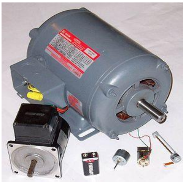
Рисунок 2.1 – Електродвигуни різної потужності (750 Вт, 25 Вт, до CD-плеєра, до іграшки, до дисководу). Батарейка «Крона» дана для порівняння.
