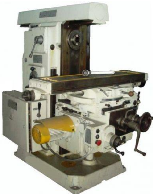
Рисунок 11.7 – консольно-фрезерний універсальний верстат моделі 6Р81
