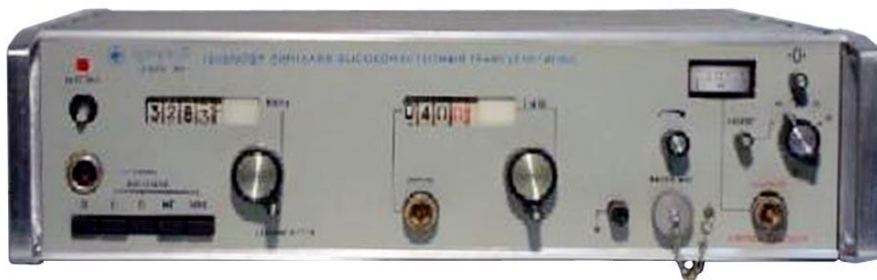
Рисунок 3.1 – Генератор високої частоти серії Г4-78 / 83.
