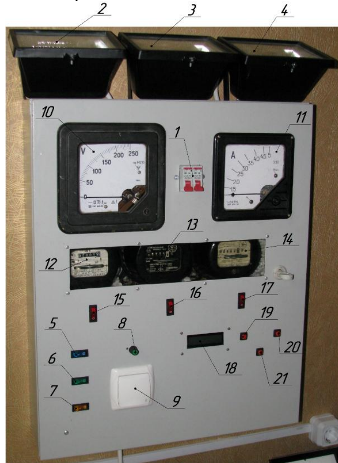
Рис. 4.3. – Лабораторний стенд для дослідження нормованих метрологічних характеристик
