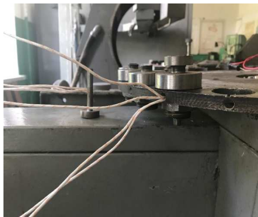
Рис. 8. Вимірювання температури за допомогою термопар «хромель-капель»
