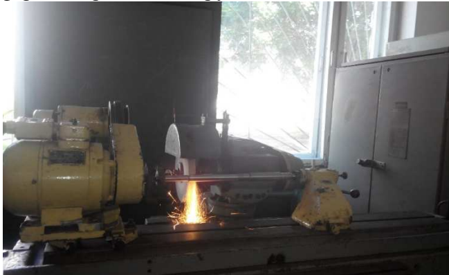
Рис. 3. Процес чистового однопрохідного шліфування вала
