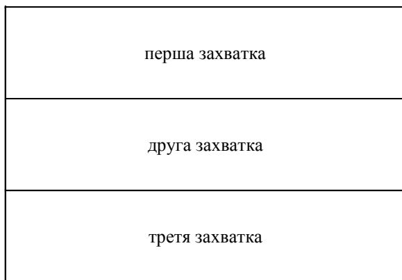
Рис. 10. Схема розбивки будівлі на захватки (приклад)
