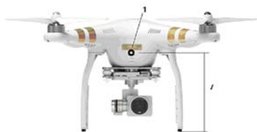
Рис. 2. Квадрокоптер Phantom-3 з візирними марками
