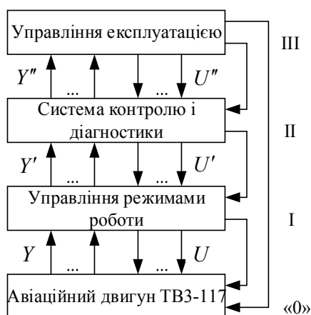
Рис. 1. Функціональна схема багаторівневої системи управління авіаційним двигуном ТВ3-117
