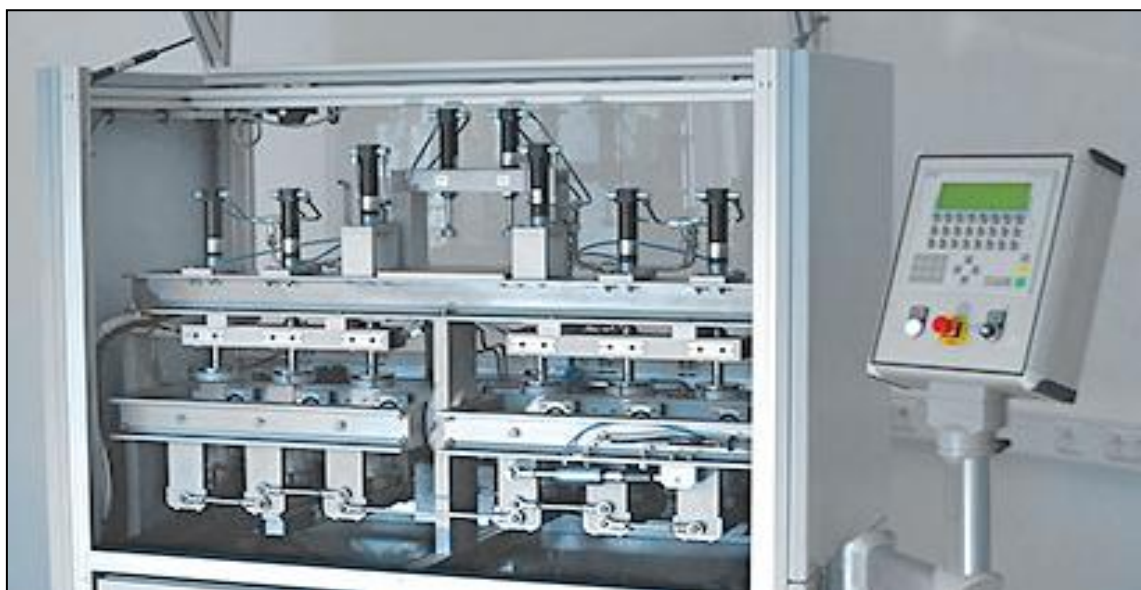
Abb. 1 – Simulator des menschlichen Gehens im Uniklinikum OVGU Magdeburg
