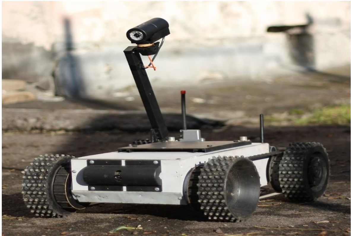
Рис.2 – Дослідний зразок малого мобільного робота для розвідки і моніторингу
