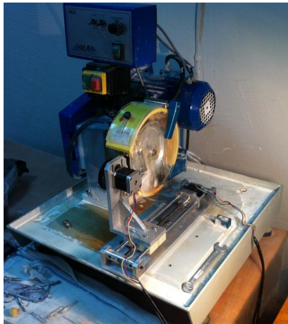
Рис. 2 – Верстат моделі SKU фірми Avalon (Польща), обладнаний макетом-приставкою автоматичної радіальної подачі кульок
