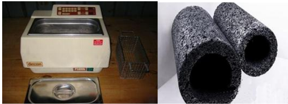
Рис. 1 – Зовнішній вигляд ультразвукової ванни моделі DECON FS-100 В та фільтрувального елемента
