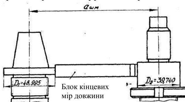
Рисунок 3.3 – Схема налаштування міжцентроміра за допомогою блоку плоскопаралельних кінцевих мір.
