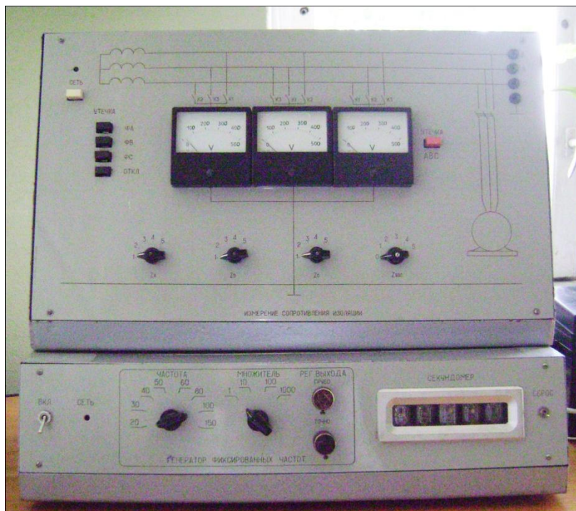
Рисунок 8.2 – Стенд для контролю ізоляції методом трьох вольтметрів
