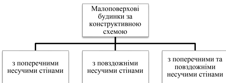
Рис. 2.5 – Класифікація малоповерхових будинків за конструктивною схемою
