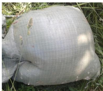
Рис. 1 – Увеличенный объем затвердевшей полимерной смеси при ее закачке в мешок при возможности свободного расширения
