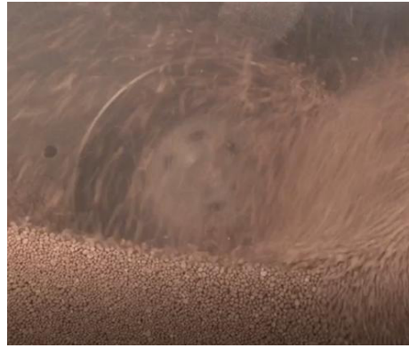
Рис. 2 – Фотофіксація руху гранул у внутрішній частині диспергатора
