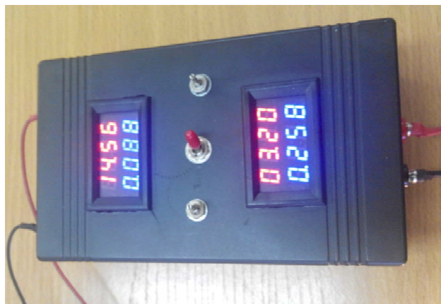
Рис. 3. Зовнішній вигляд лабораторного джерела живлення
