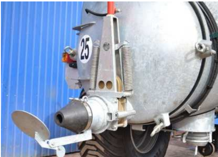
Рисунок 2.31 – Система зливання питної води
