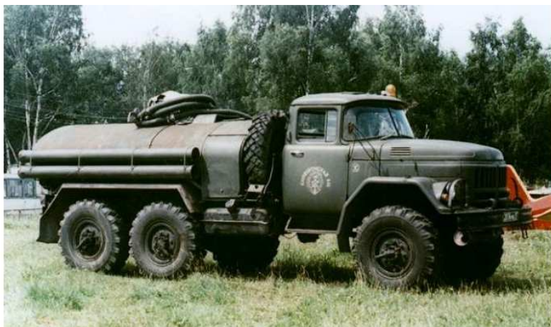
Рисунок 6.38 – Заправна автоцистерна АЦ 4,0 131 на шасі ЗІЛ-131 з насосним обладнанням
