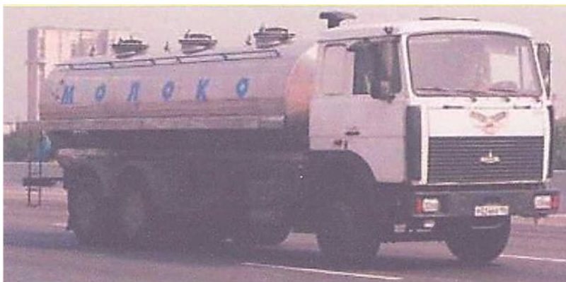
Рисунок 3.43 – Автоцистерна для молочних продуктів БЦМ-138 підмосковного заводу «Бецема», яка встановлена на шасі VOLVO FH12
