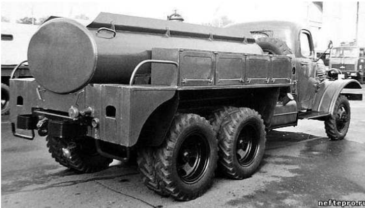
Рисунок 6.35 – Авторозливальна станція АРС-12Д з бічними бачками для спец рідин
