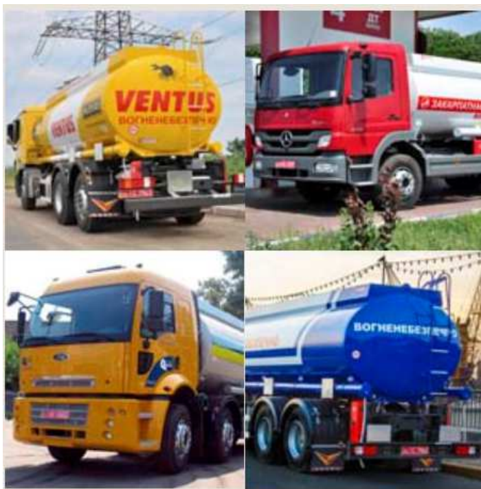
Рисунок 6.99 – Цистерни, які виготовлені компанією «Еверласт» та встановлені на шасі різних авто
