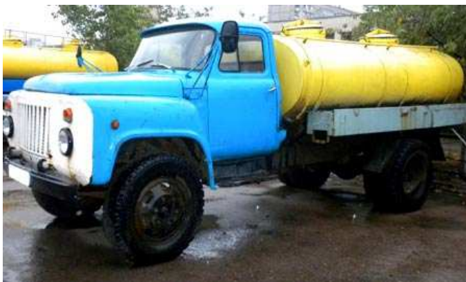
Рисунок 4.4 – Загальний вигляд автомобіля ГАЗ-53 з автоцистерною АЦПТ-1,7 для перевезення пива або квасу
