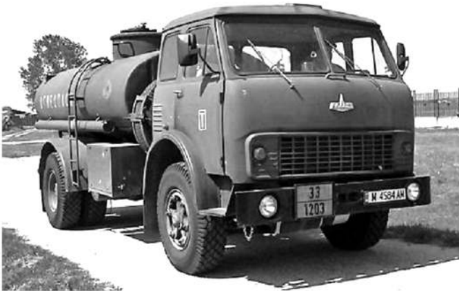
Рисунок 6.51 – АЦ-8-5334 на шасі МАЗ-5334 (паливна автоцистерна з насосним обладнанням)
