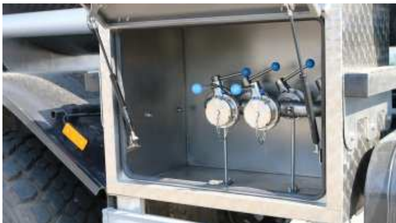
Рисунок 2.26 – Місця під'єднання зливних рукавів
