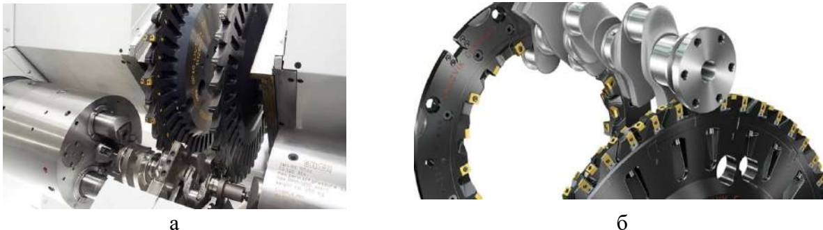
Рисунок 1 – Фрезерування кількома фрезами одночасно: а – Heller; б – Sandvik
