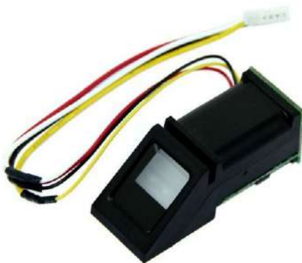
Рисунок 1 – Сканер відбитку пальців ZFM-20.
