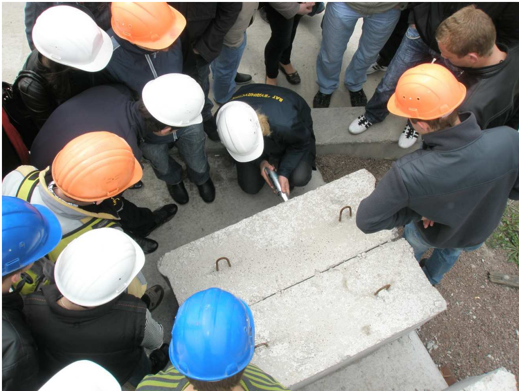
Рис. 3.4 – Дослідження бетону молотком Шмидта
