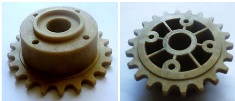
Рис. 9. Зірочка, інтегрована з барабаном і кришкою кріплення
