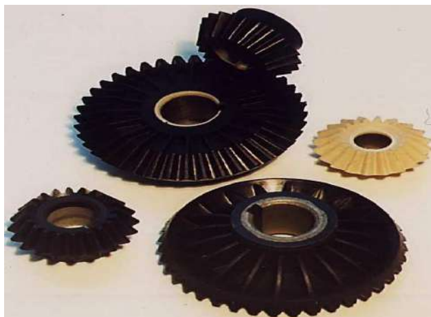
Рис. 23. Конічні прямоzubі шестерні ЧФ-30, ЧФ-34 і зубчасте колесо ЧФ-31 (табл. 6)
