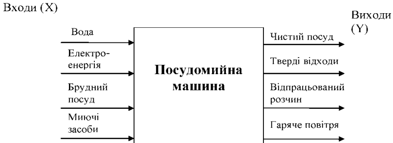
Рис. 2.6. Модель чорної скрині на прикладі системи «Посудомийна машина»
