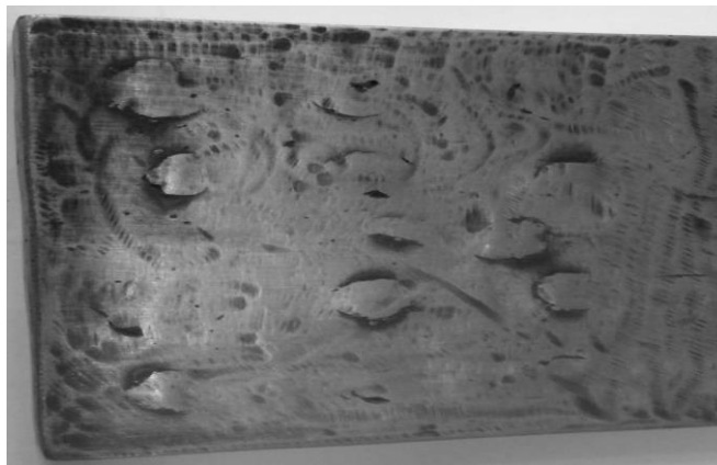
Рис. 12. Верхня поверхня пластини основи біметалу після заплавлення технологічних отворів електродуговою зваркою та подальшої зачистки [3; 5; 11]
