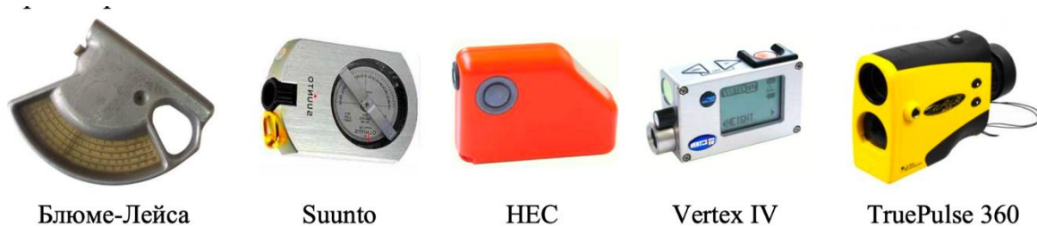
Рисунок 2.3 – Механічні та електронні висотоміри тригонометричного принципу дії
