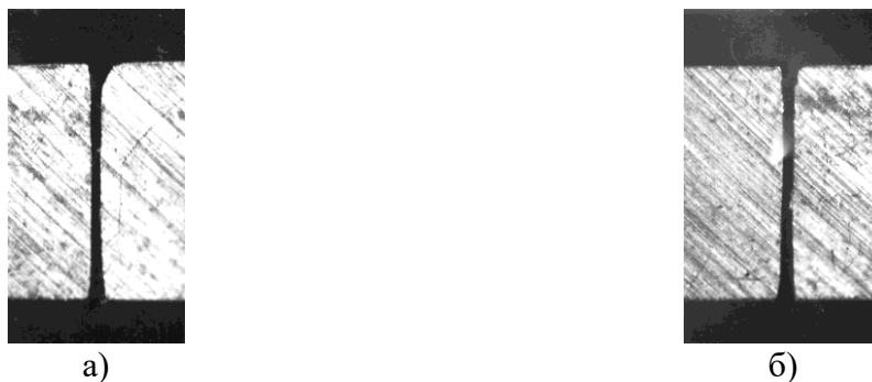
Рис. 3 – Розширення різу поблизу верхньої поверхні металу при різці без а) та з попереднім деформуванням металу б)
