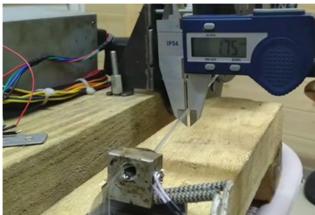
Рис. 3 – Точність діаметру філаменту
