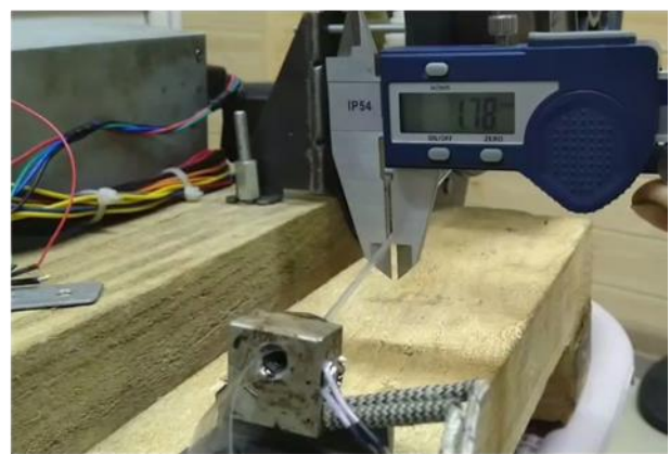
Рис. 3 – Точність діаметру філаменту
