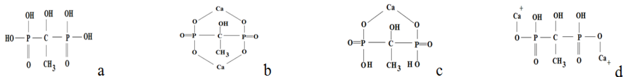
Рис. 1 – Схематична структура ОЕДФ та осадів комплексу, що утворюються з іонами кальцію: а - структура ОЕДФ; б - \text{Ca-HEDP} (2:1); с - \text{Ca-HEDP} (1:1); д - \text{Ca-HEDP} (1:1)
