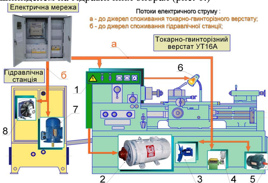
Рис. 1 – Схема електричного споживання основних елементів верстата з шпиндельним вузлом з гідравлічними опорами: 1 – електрошафа верстату; 2 – електропривод головного руху (постійного струму); 3 – електродвигун примусового повітряного охолодження; 4 – електродвигун для прокачування мастильно-охолоджуючої рідини (МОР); 5 – електродвигун прискореної подачі; 6 – місцеве освітлення; 7 – електродвигун насосної установки; 8 – електродвигун теплообмінника
