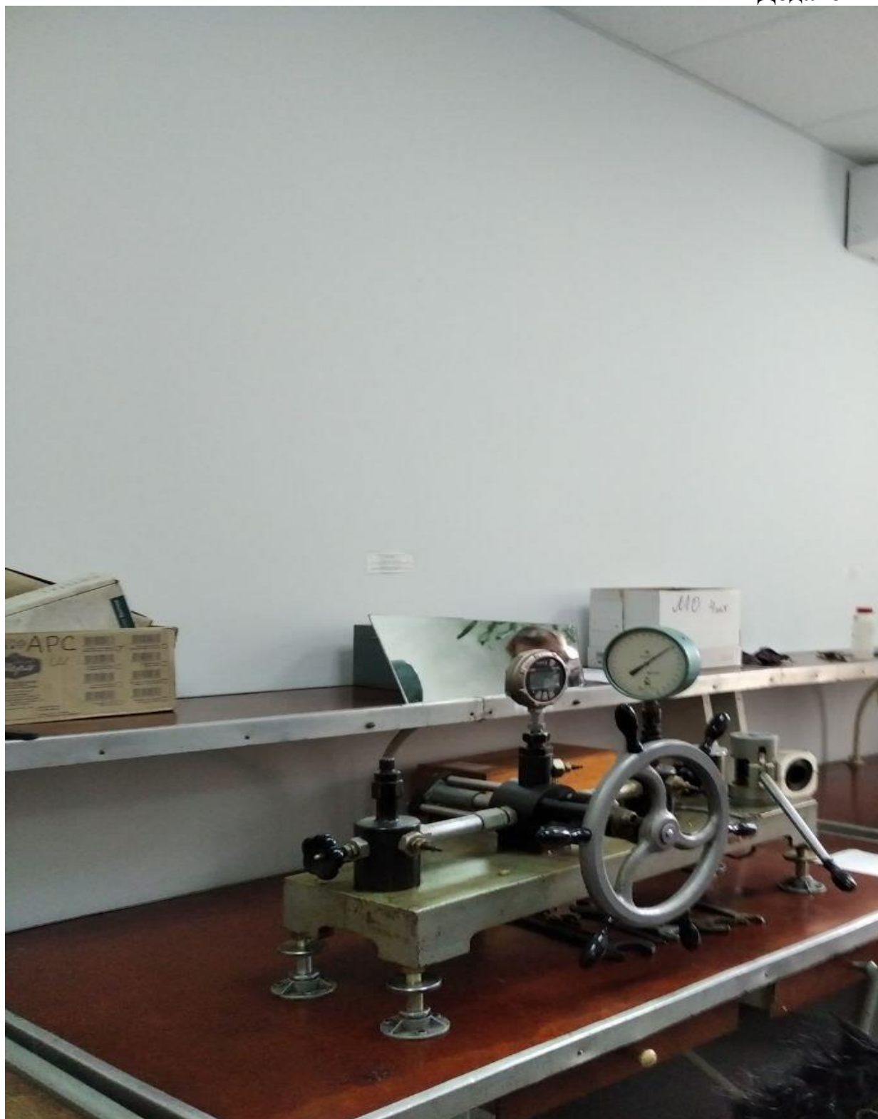
Рисунок 1 - Повірка монометрів у ДП ЧЕРНІГІВСТАНДАРТМЕТРОЛОГІЯ» для вимірювання тиску на обладнанні підприємств харчової промисловості
