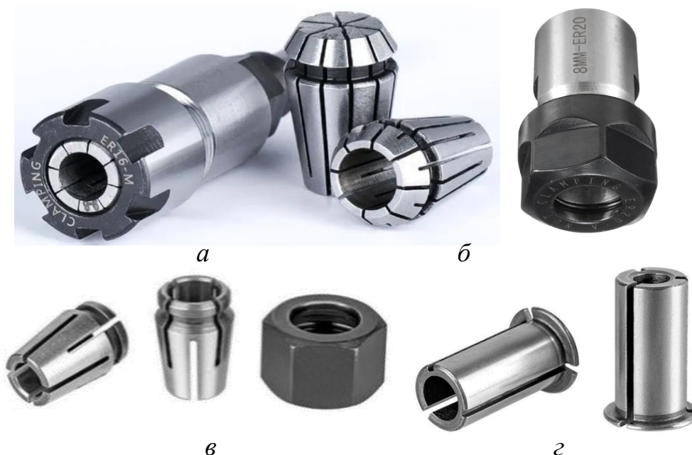
Рисунок 3.2 – Цангові патрони (а, б) та цангові втулки (в, г) для закріплення фрез
