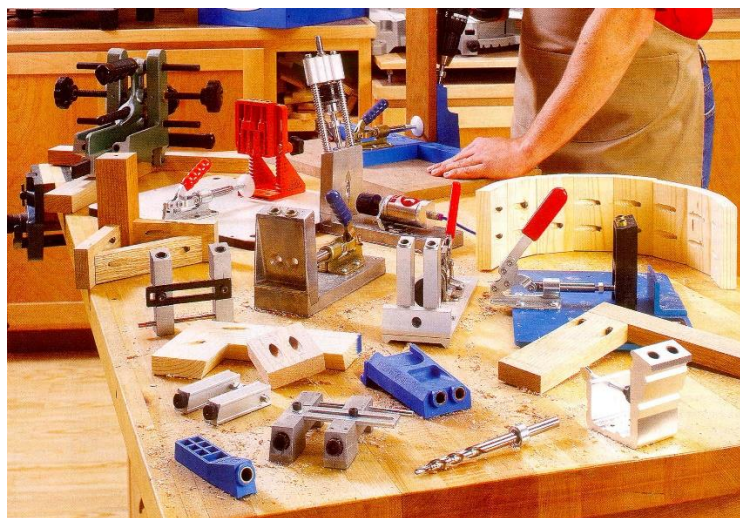
Рисунок 4.4 – Кондуктори для свердління косих отворів а) та приклад застосування б)
