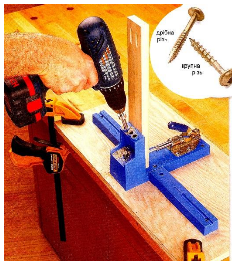
Рисунок 4.4 – Кондуктори для свердління косих отворів а) та приклад застосування б)
