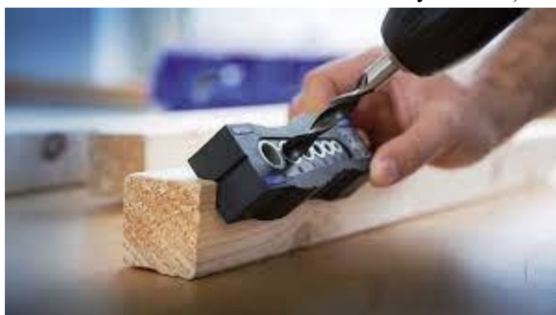
Рисунок 4.5 – Приклади застосування кондукторів для свердління отворів під кутом
