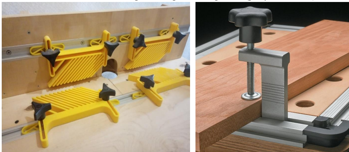
Рисунок 2.1 – Притискні а) та затискний б) механізми технологічного оснащення для деревообробки
