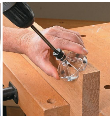
Рисунок 4.5 – Приклади застосування кондукторів для свердління отворів під кутом
