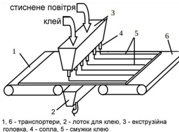
Рисунок 3.2 – Схема екструзійного верстата для нанесення клею
