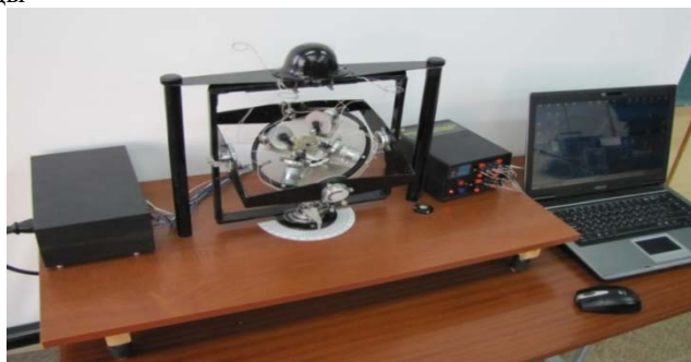
Рис.2. Макет микроспутника с электромаховичными приводами пирамидальной структуры
