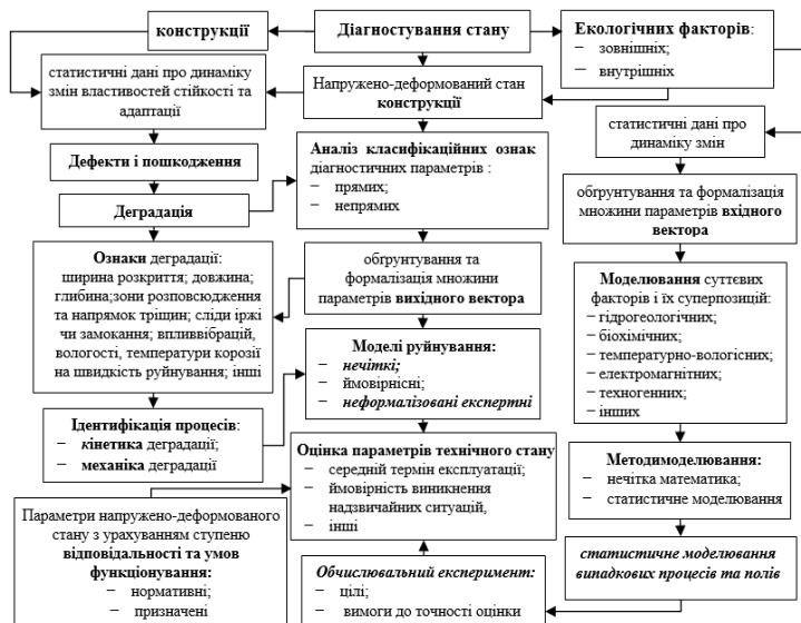
Рис. 1. Структура інтелектуальної системи оцінки технічного стану архітектурних конструкцій
