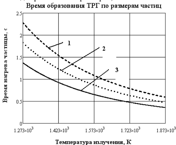
Рис. 2. Зависимость времени нагрева частиц до превращения в TRG от температуры излучения. 1 – частица, диаметром 0,5 мм, 2 – частица, диаметром 0,4 мм, 3 – частица, диаметром 0,3 мм
