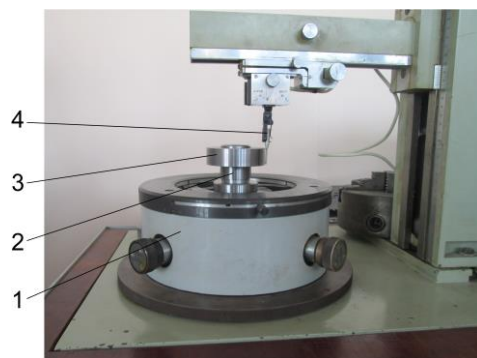
Рисунок 12 – Загальний вигляд а) та принципова схема визначення частоти обертання шпинделя б)
