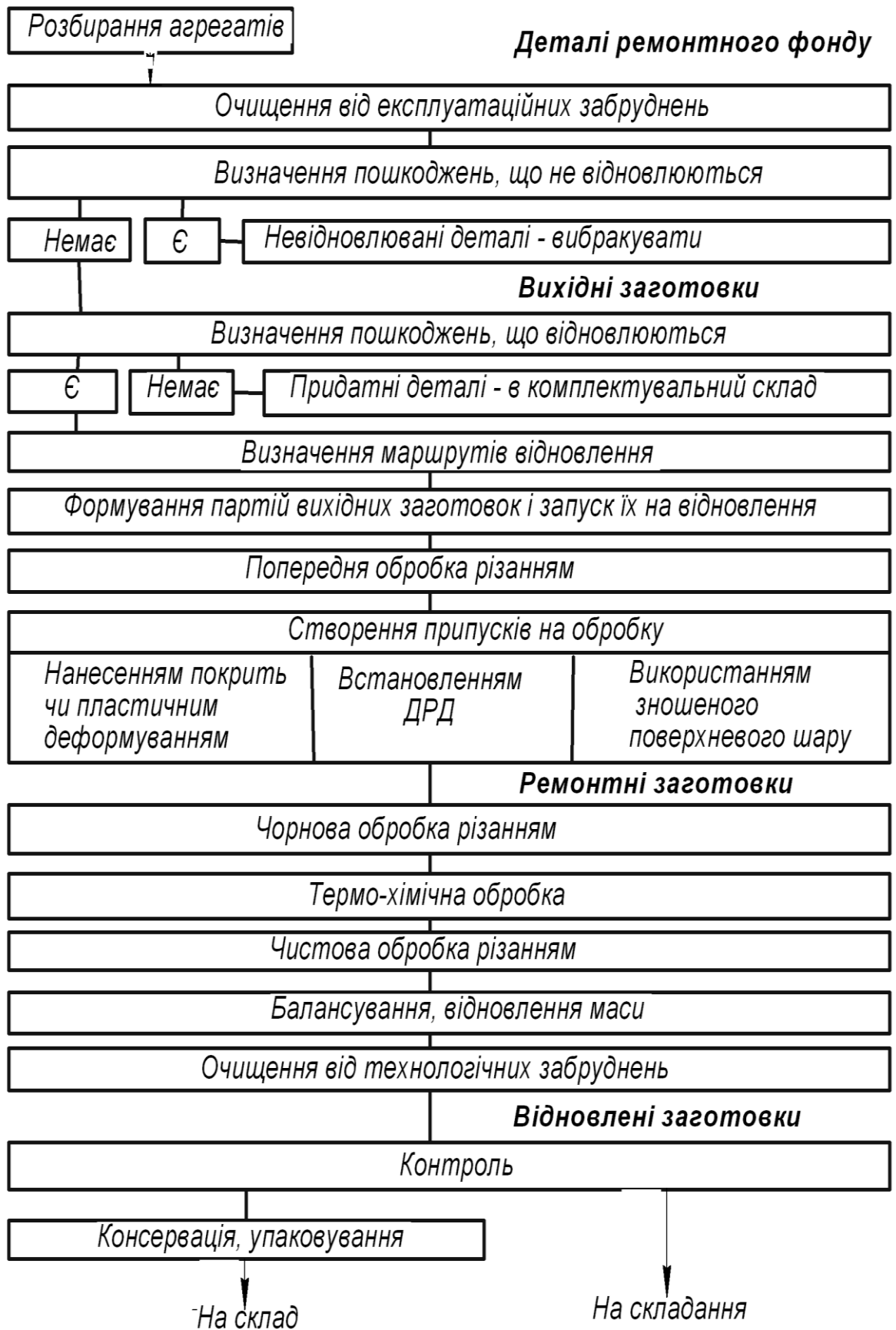
Рис.1.2. Схема технологічного процесу відновлення деталей
