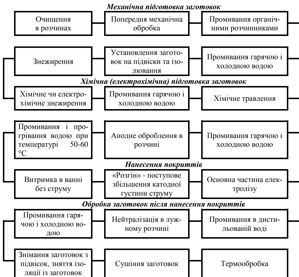
Рис. 6.1. Схема технологічного процесу нанесення електрохімічних покриттів
