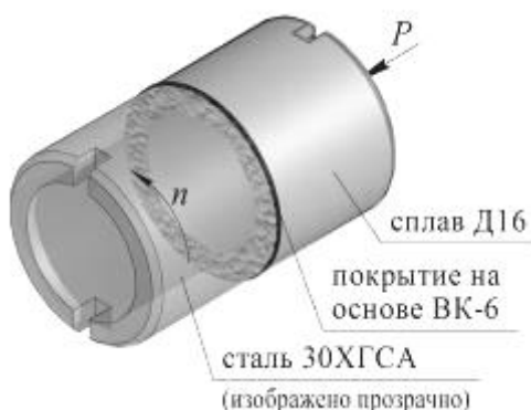
Рис. 1. Схема взаимодействия образцов при испытании на износ
