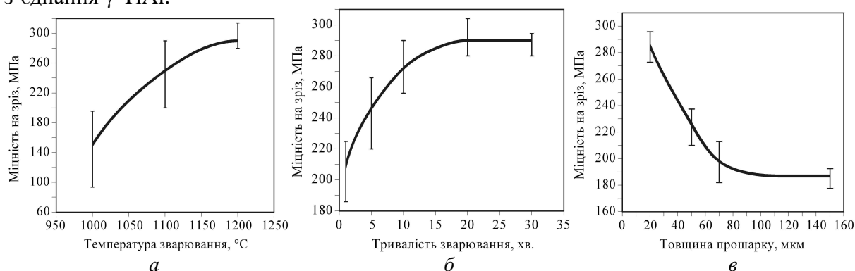
Рис. 2. Графіки впливу температури (а), часу зварювання (б) і товщини БФ Al/Ti на міцність зварних з'єднань
