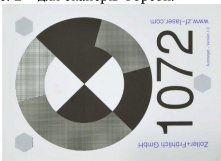
Рис. 1. Схема точкової марки, що використовується зі сканерами Z+F
