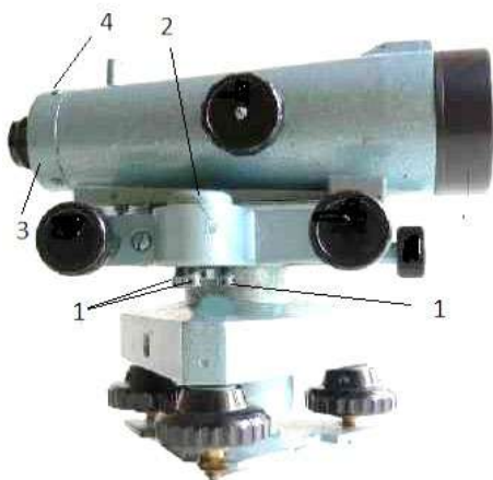
Рис. 2.81. До першої перевірки: 2 – круглий рівень; 1 – виправні гвинти круглого рівня.
