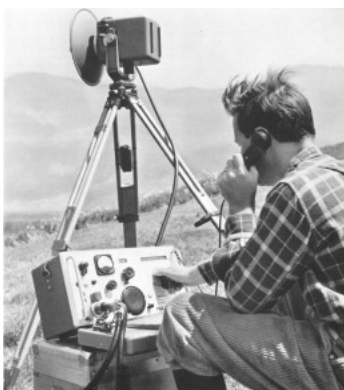
Рис. 2.61. Польові роботи з використанням радіовіддалеміра Дістомат DI50
