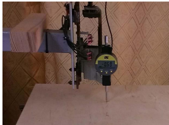
Рис. 1 – Випробування різних конструкцій столярних плит із ВЖД ялини
