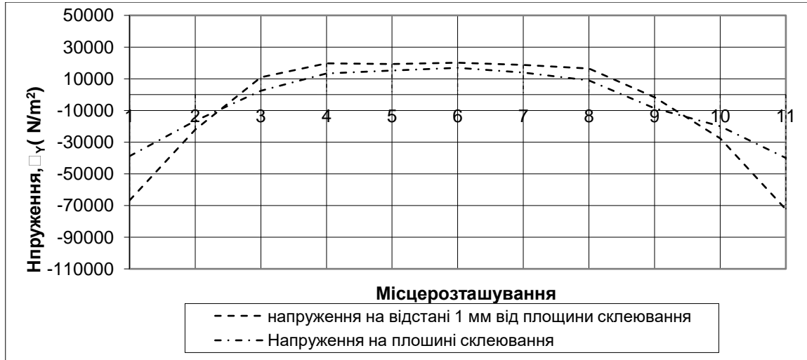
Рис. 2 – Розподіл радіальних напружень у клейовому шві.
